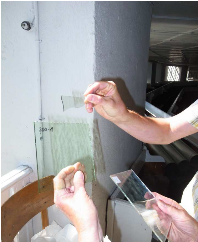
Vergleich neuer Scheibenproben (sog. Goetheglas) mit bauzeitlichem Fensterglas, August 2012
